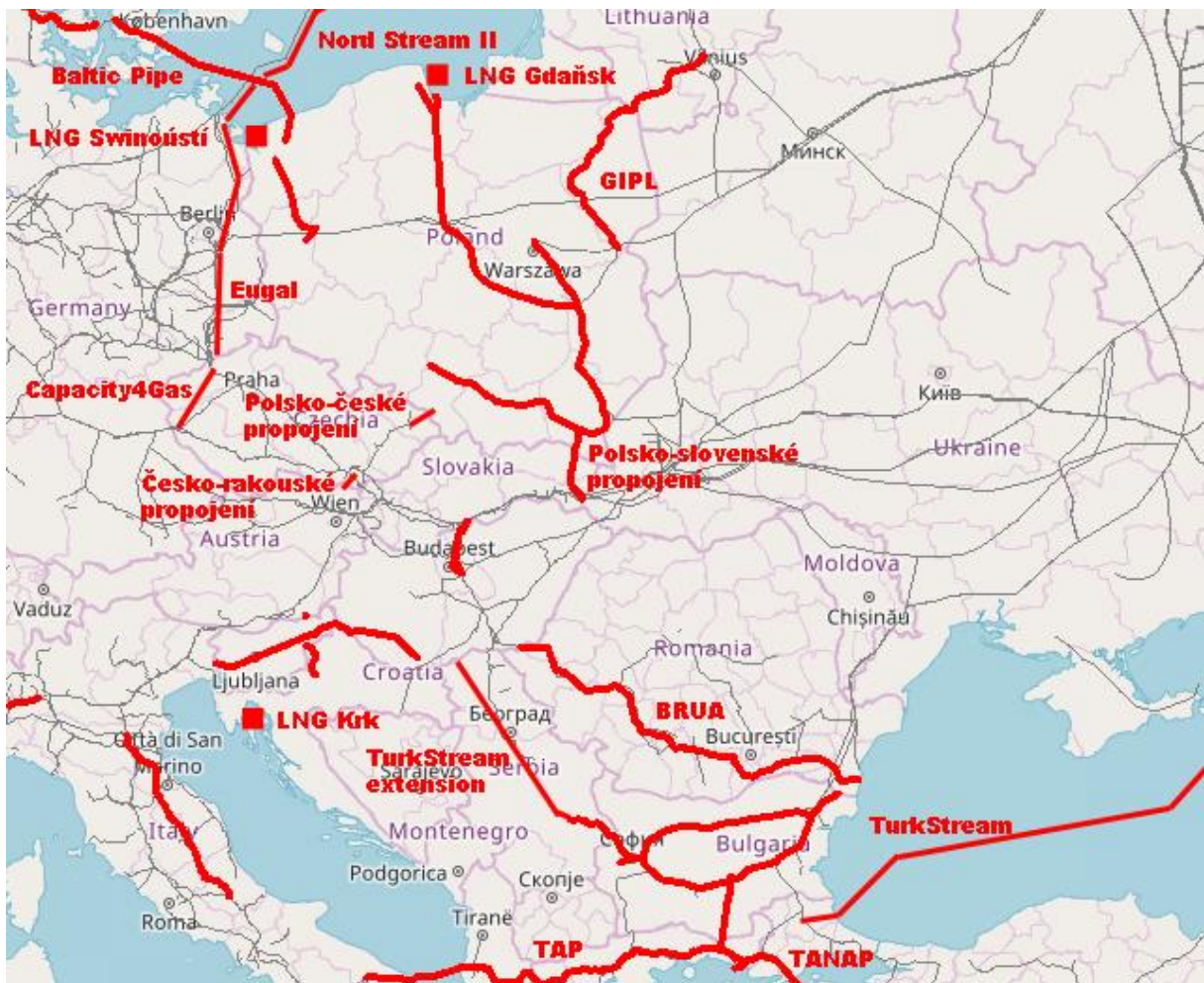
Obrázek 20 – Rozvojové projekty plynovodů a LNG terminálů
