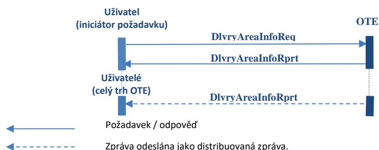
Obrázek 17 – Sekvenční schéma provedení dotazu na oblasti dodávky
