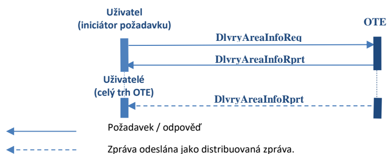
Obrázek 17 – Sekvenční schéma provedení dotazu na oblasti dodávky
